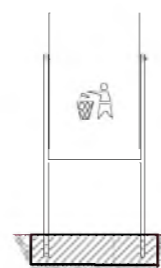
Фундамент 1 шт. 600х200х300мм Бетон В12,5
