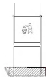
Фундамент 1 шт. 600х200х300мм Бетон В12,5
